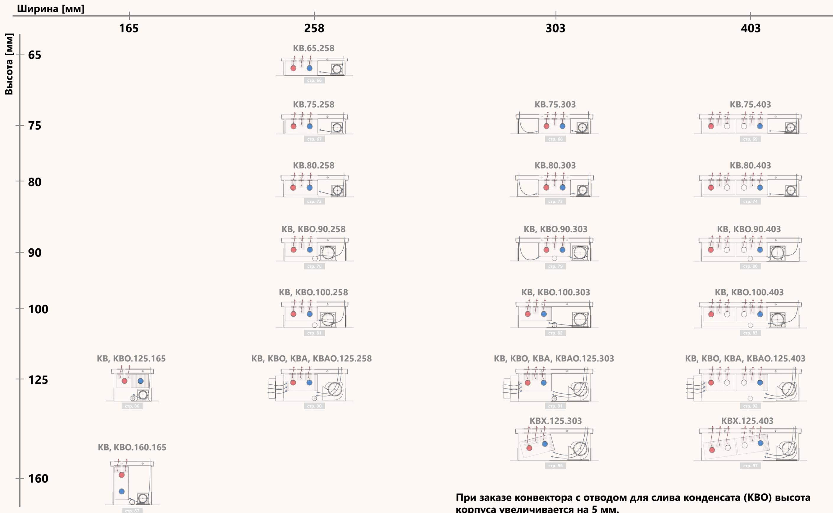
При заказе конвектора с отводом для слива конденсата (KBO) высота корпуса увеличивается на 5 мм.
