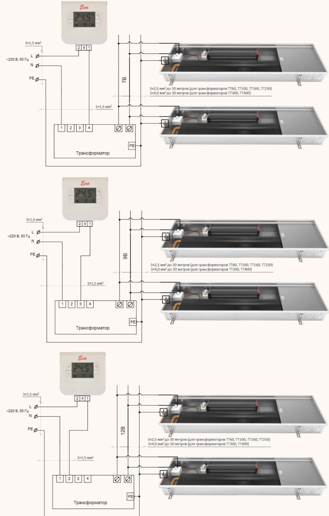
При подключении к трансформаторам ТТ60, ТТ100, ТТ160, ТТ250 использовать провод 3x2,5 мм<sup>2</sup> до 30 метров
